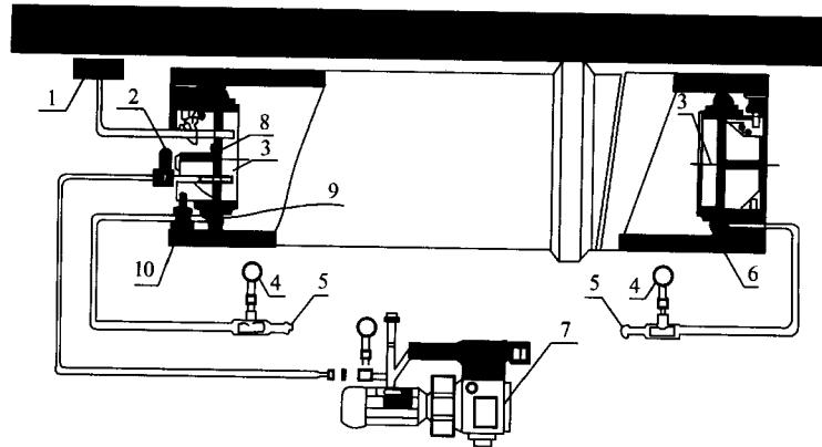
图 E. 0.1 排水管道闭气检验装置图
