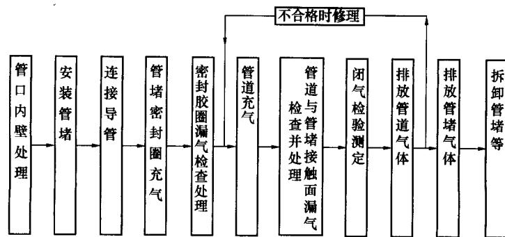
图 E. 0.2 管道闭气检验工艺流程图
